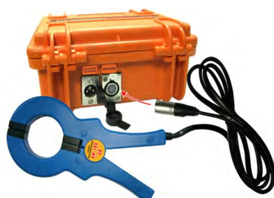
1.15.2 Работа прибора с передающими «клещами» аналогична работе с «клипсами» («кабелем выходным» с разъемами «крокодил»). Соответственно индицируются: напряжение сигнала на «клещах» «U, В» / ток сигнала в «клещах» (не в коммуникации) «I, А» / мощность потребляемая «клещами» «P, Вт» / импеданс «клещей» (не коммуникации) на данной частоте «R, Ом/кОм». Ток, потребляемый «клещами», обратно пропорционален частоте сигнала при неизменном его напряжении.
