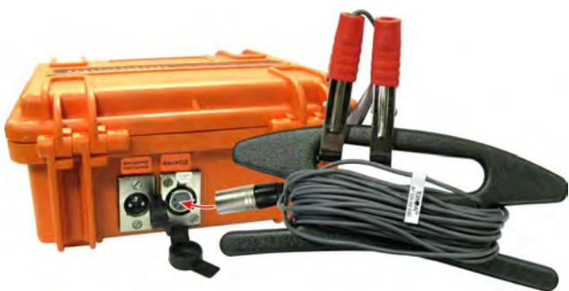
1.12.1 Если «клипсы» подключены к разъему «ВЫХОД», то прибор готов к «контактному» подключению нагрузки. Встроенная передающая антенна «LC» отключена (индикатор «АНТЕННОГО» режима не светится)
